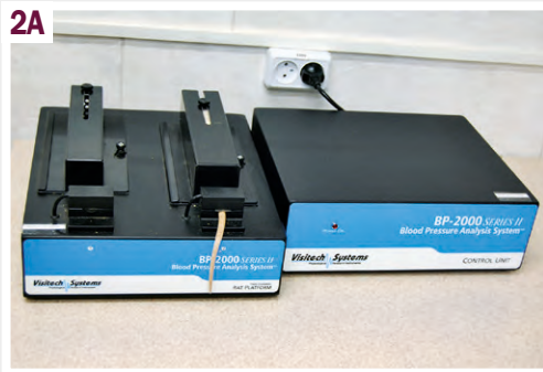
Рис 2. А: система неінвазивної реєстрації артеріального тиску BP-2000 з одномоментним вимірюванням АТ у двох щурів, розміщених в ізоляційних тунелях на термоплатформах; Б: графічне зображення вимірювання артеріального тиску.
